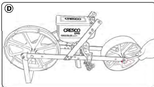
Riallineare il foro centrale della ruota posteriore al foro posteriore del telaio, serrare il dado per fissare la ruota posteriore).
